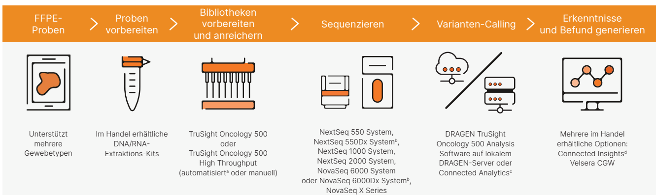
Abbildung 2: TruSight Oncology 500-Workflow: TruSight Oncology 500 und TruSight Oncology 500 High-Throughput lassen sich in aktuelle Labor-Workflows integrieren. Die Verarbeitung von Nukleinsäuren bis zu den Varianten-Calls nimmt vier Tage in Anspruch.
