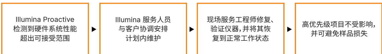
图 1: ILLUMINA Proactive 在行动示例 — 在此示例中，通过例行监控系统性能数据检测到光学硬件故障风险，从而针对一个高优先级项目进行了计划内维护。避免了在时间、人工和样品方面可能造成的高昂损失。
