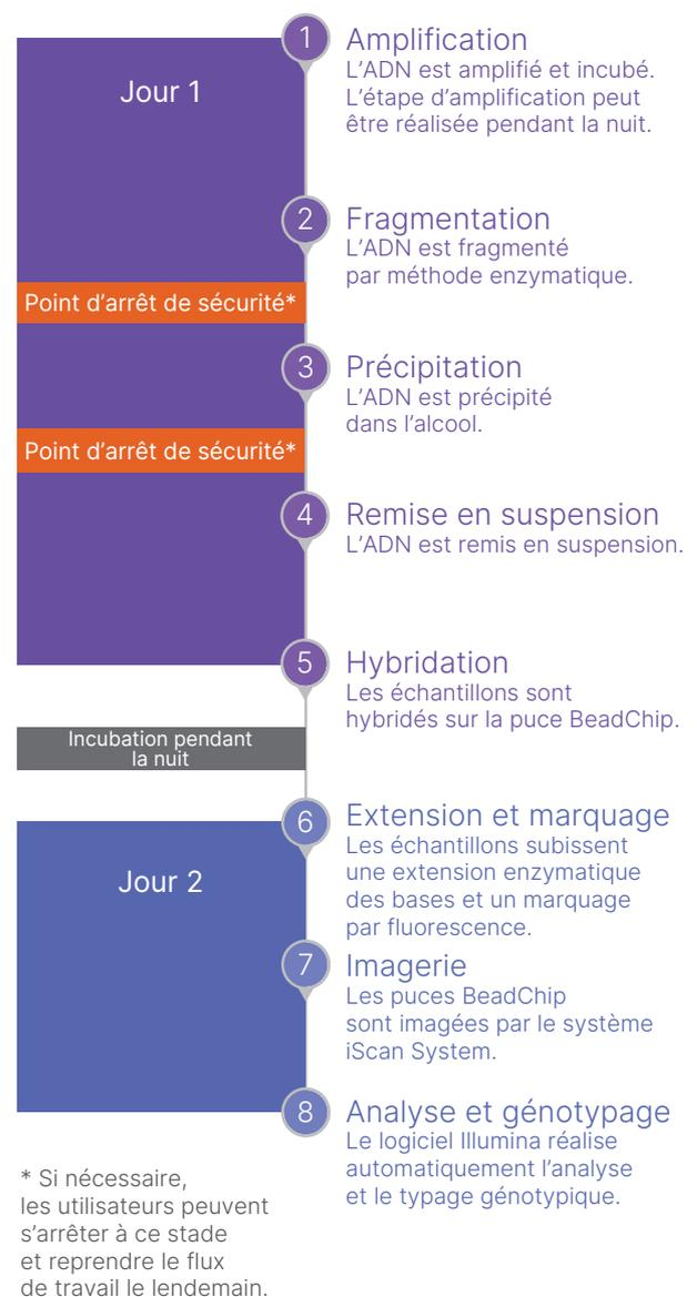
Figure 7 : Flux de travail de la chimie Infinium EX à 48 échantillons – Le flux de travail de la chimie Infinium EX à 48 échantillons propose un flux de travail optionnel de deux ou trois jours avec une durée de manipulation minimale.
