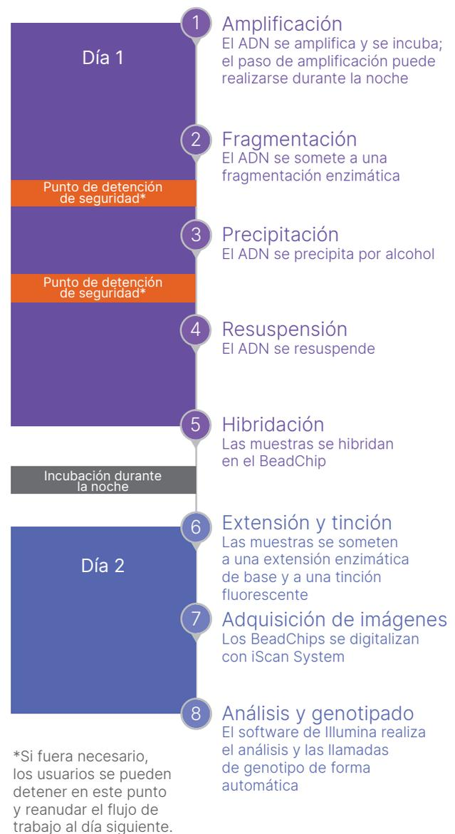
Figura 7: Flujo de trabajo de 48 muestras de Infinium EX. El flujo de trabajo de 48 muestras de Infinium EX proporciona un flujo de trabajo opcional de dos o tres días con un tiempo de participación activa mínimo.
