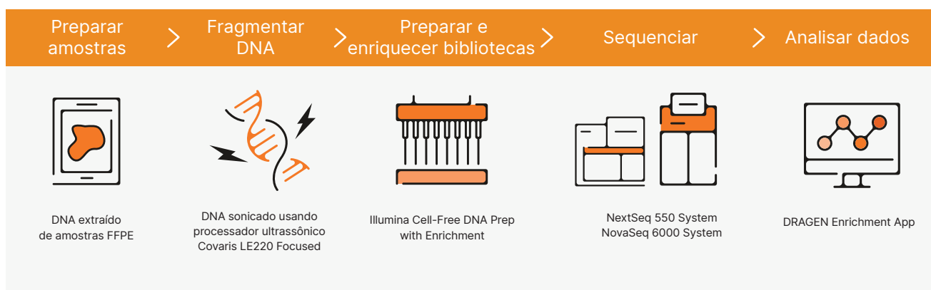
Figura 1: fluxo de trabalho do Illumina Cell-Free DNA Prep with Enrichment para processamento de amostras FFPE.
