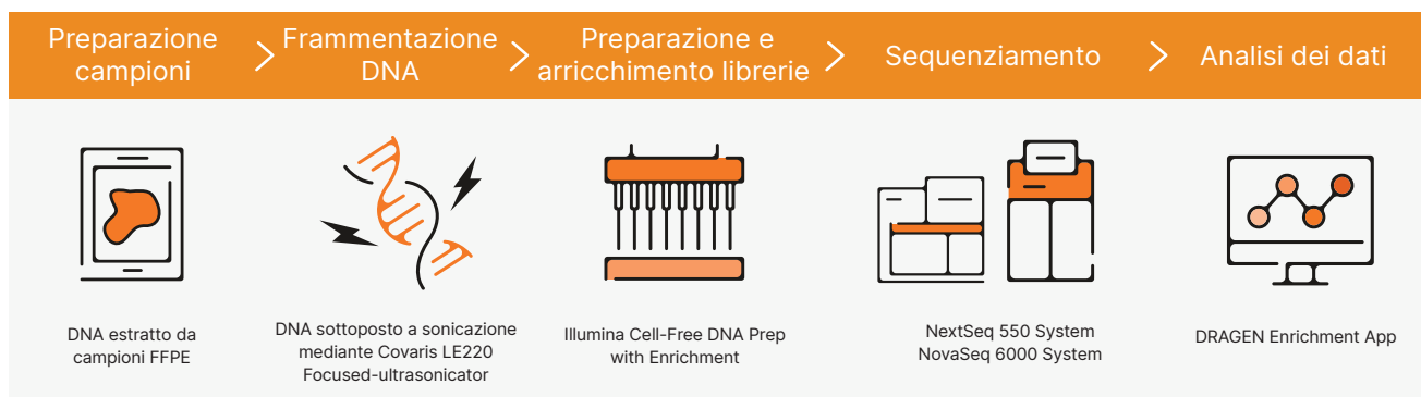
Figura 1: flusso di lavoro di Illumina Cell-Free DNA Prep with Enrichment per l'elaborazione di campioni FFPE.
