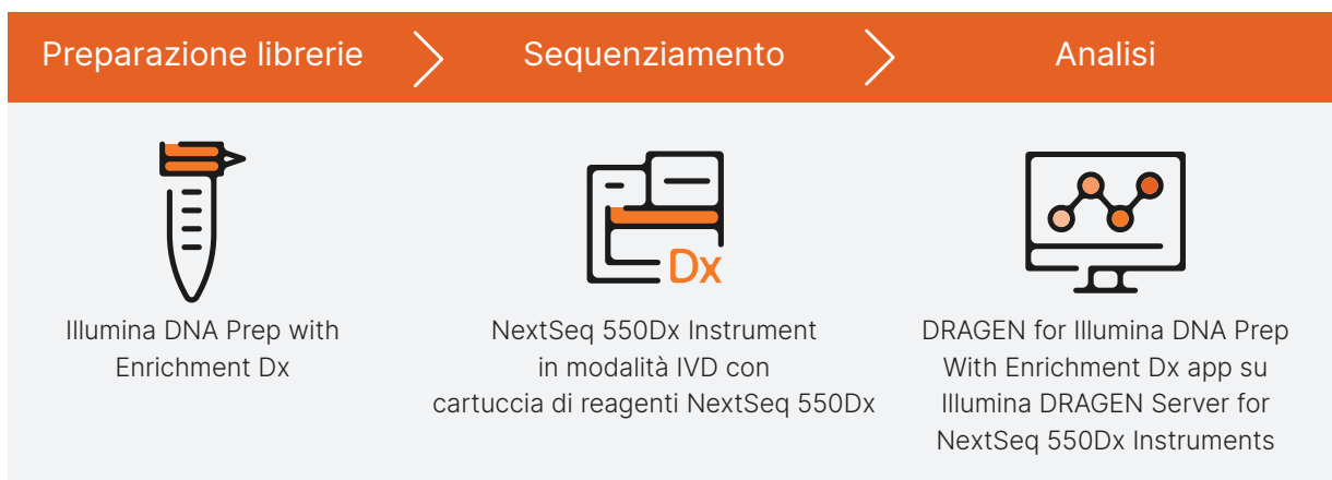
Figura 1: analisi NGS conforme a IVDR dei campioni su DRAGEN Server for NextSeq 550Dx Instruments. Il flusso di lavoro di sequenziamento mirato include la preparazione delle librerie di campioni estratti con il flusso di lavoro NGS di Illumina DNA Prep with Enrichment Dx, il sequenziamento su NextSeq 550Dx Instrument e l'accurata analisi conforme al regolamento IVDR eseguita su DRAGEN Server for NextSeq 550Dx Instruments.
