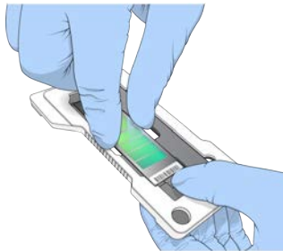
Obrázok 20 Usadenie a upevnenie čipu BeadChip
