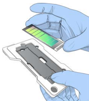
Obrázok 19 Vloženie čipu BeadChip do adaptéra
