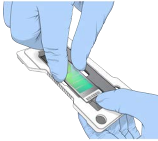
Afbeelding 20 Plaats en bevestig de BeadChip
