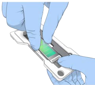
Slika 20 Namještanje i učvršćivanje pločice BeadChip
