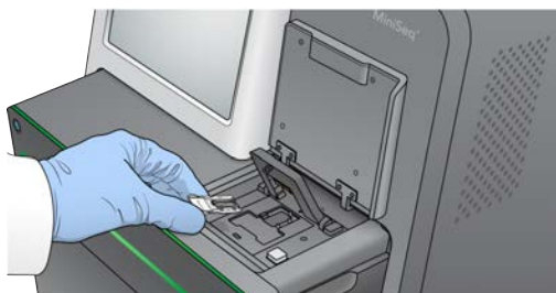
图 18 将流动槽放在流动槽台上
