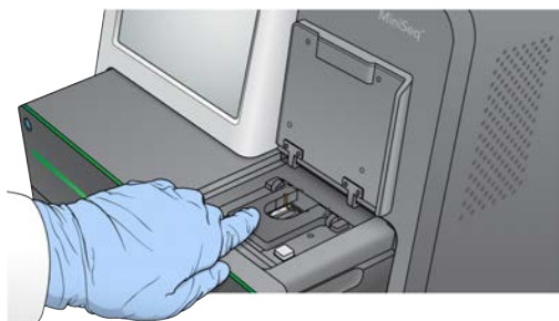
图 19 关闭流动槽锁
