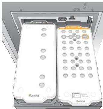
5. Deslize a gaveta para dentro do refrigerador e, em seguida, feche a porta do refrigerador de reagentes.
