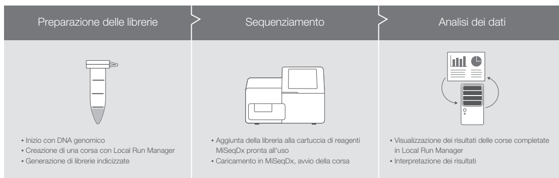
Figura 2. Procedura in tre fasi del saggio MiSeqDx: lo strumento MiSeqDx fa parte di una procedura integrata che comprende la preparazione delle librerie e l'analisi dei dati per i test di diagnostica molecolare. I report dettagliati sui risultati sono disponibili solo per i saggi specifici per i target, come Extended RAS Panel, TruSight Cystic Fibrosis 139-Variant Assay e TruSight Cystic Fibrosis Clinical Sequencing Assay.
