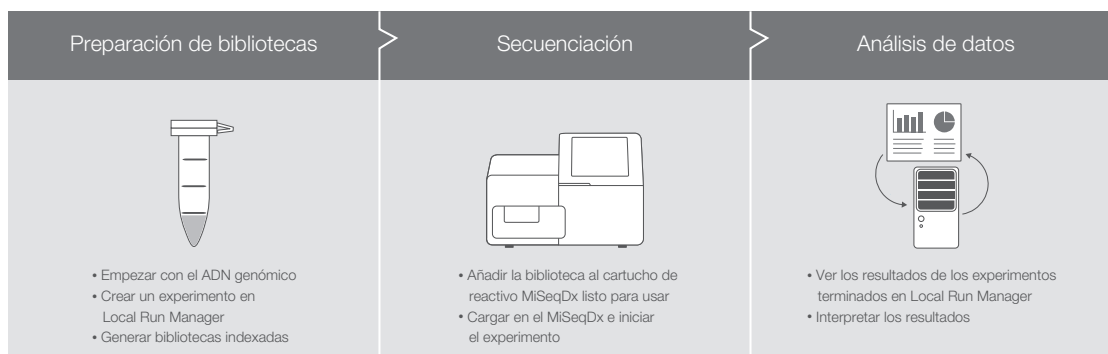
Figura 2: Procesos para ensayos de MiSeqDx en tres pasos. MiSeqDx Instrument forma parte de un proceso integrado que incluye la preparación de bibliotecas y el análisis de datos para ensayos diagnósticos moleculares. Solo hay informes con resultados detallados en los ensayos específicos según el objetivo como, por ejemplo, el Extended RAS Panel, el ensayo de 139 variantes de la fibrosis quística TruSight y el ensayo de secuenciación clínica de la fibrosis quística TruSight.
