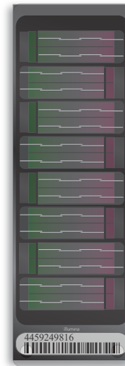
Abbildung 1: Infinium Global Diversity Array with Cytogenetics-8 v1.0 BeadChip: Wirtschaftliche zytogenetische Analyse von bis zu 8 Proben auf Basis der zuverlässigen LCG-Plattform von Infinium. Der BeadChip umfasst ca. 1,8 Mio. sorgfältig ausgewählte Marker und dedizierte Softwareanalysetools für Forschungsanwendungen.
