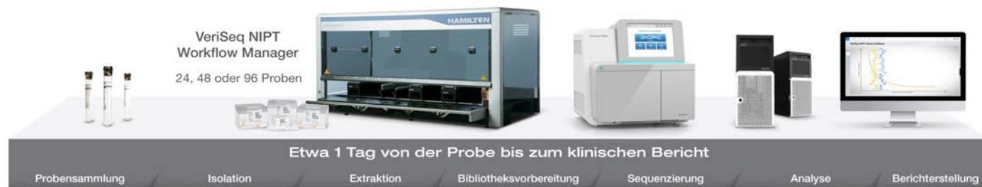
Abbildung 1: Vollständiger IVD-NIPT-Workflow: VeriSeq NIPT Solution v2 bietet alles, was für NIPT mit NGS benötigt wird, darunter Reagenzien für die DNA-Extraktion, Bibliotheksvorbereitung und Sequenzierung, Geräte für die automatisierte Bibliotheksvorbereitung und Sequenzierung mit Workflow-Manager-Software, einen Vor-Ort-Server für die sichere Datenspeicherung und -analyse sowie Datenanalyse-Software, die auf das Erstellen klinischer Berichte ausgelegt ist.
